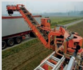
Das Überladeband ist über 2 hydraulische Drehkränze 300° nach rechts bzw. links schwenkbar
