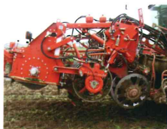
Yeni diskli sökme sistemi 45/50 cm. için uygundur.
