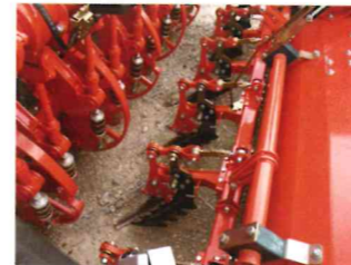
COMBI yaprak kesici - azaltılmış motor hızında yüksek bıçak mili hızı
