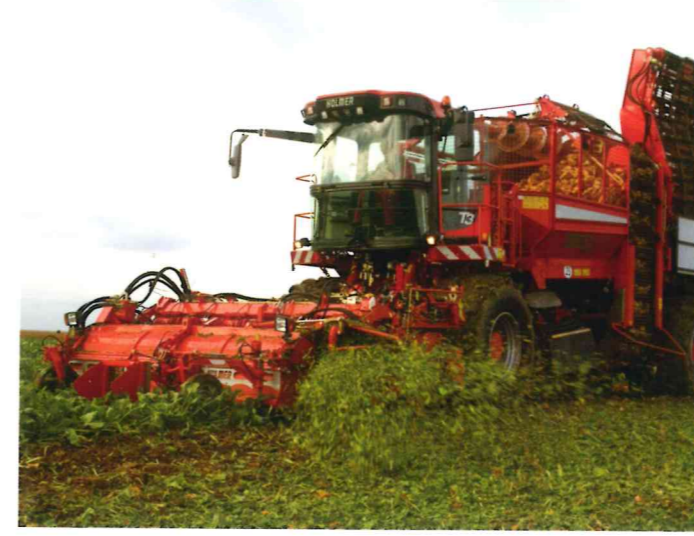
KOS (COMBI yaprak kesicisi) döven gibi çalışır
