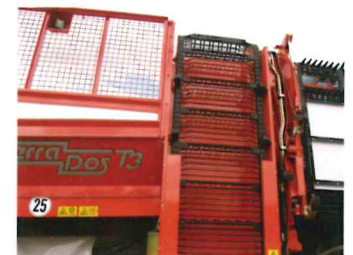
5 aşamalı asansör uygun bir asansör hızı garanti eder.
