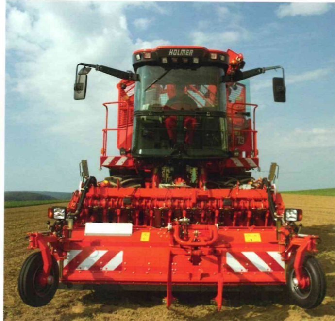
Mükemmel hassasiyeti sayesinde, şeker pancarı hasat makinesi Terra Dos T3'ün 6 sıralı sökümler ünitesi ikna edicidir.
