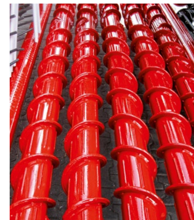
Rouleaux d'arrachage recouverts deux ou quatre fois avec spires rehaussées
